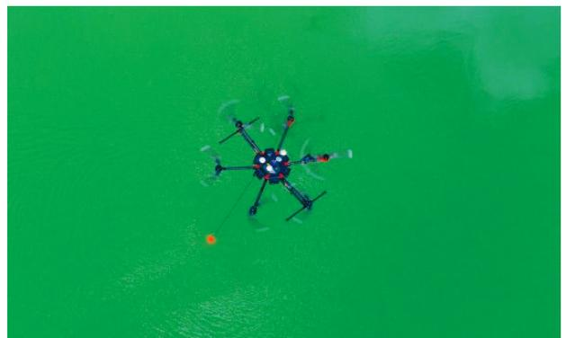
그림 2. UAV에서 음향 측심기를 사용하는 수심 측량을 위한 통합된 시스템
